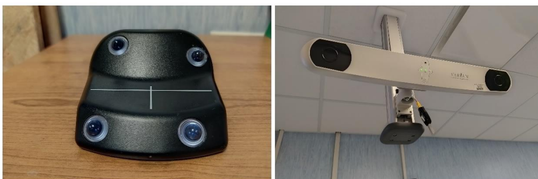
Figura 20 - RPM boxe e rilevatore di raggi infrarossi utilizzati nell'unità di trattamento
