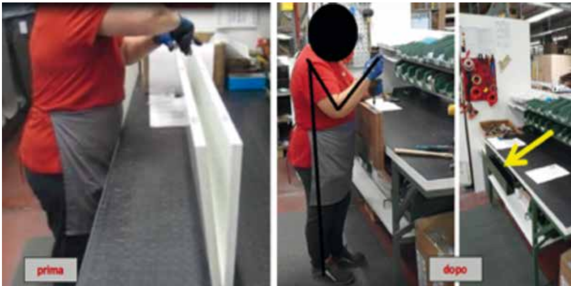
Figura 2 - Operazione di avvvitamento su pannello verticale con postura del braccio dx ad altezza superiore alla spalla (prima). La realizzazione di una tasca porta ante sotto il ripiano, ha permesso una migliore posizione delle braccia dell’operatrice (dopo)
