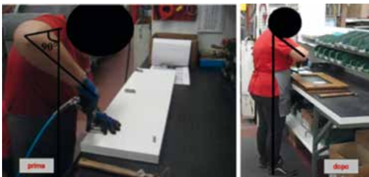
Figura 1 - Operazione di avvitarimento della ferramenta con postura del braccio dx ad altezza superiore alla spalla, mantenuta per 1/3 dell'attività (prima). L'abbassamento del tavolo di lavoro ha permesso una migliore posizione delle braccia dell'operatrice (dopo).
